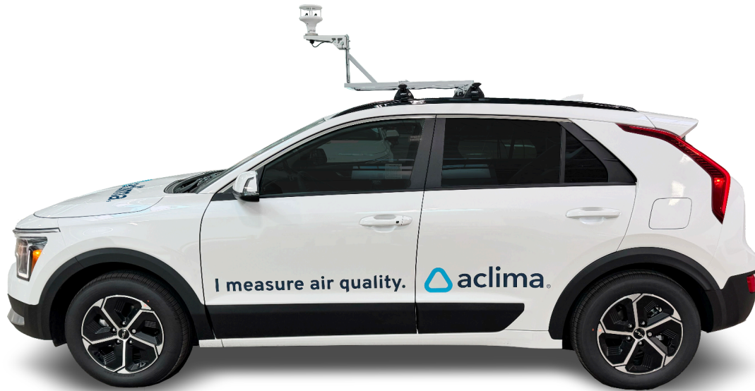
Figura 7.1: Una plataforma móvil Aclima.
