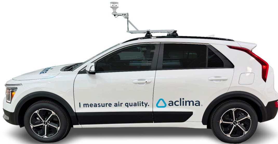
Figura 7.1: Una plataforma móvil Aclima.
