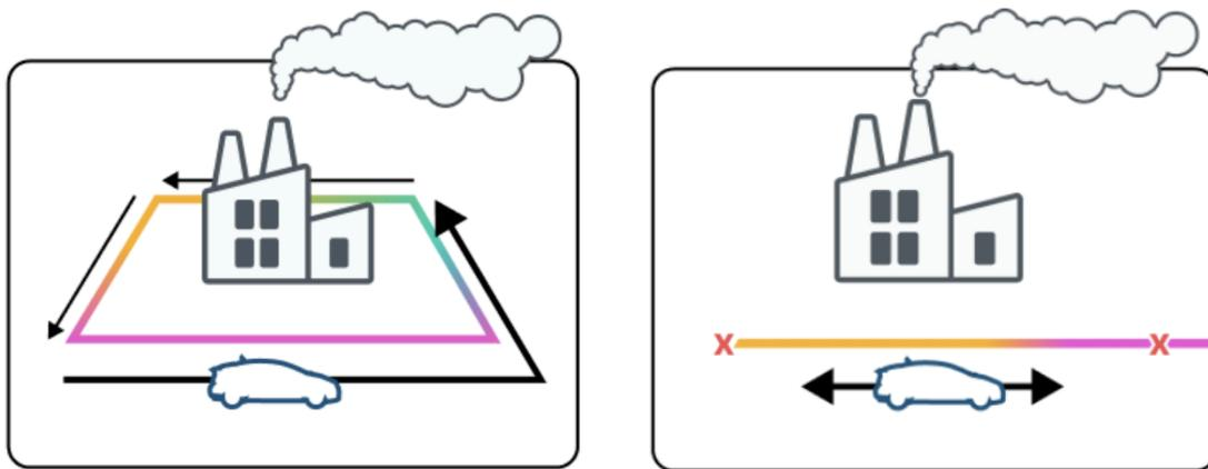
**Figura 2:** Ejemplo de técnica de medición para el monitoreo de área específica utilizando (izquierda) conducción perimetral, que sondea sistemáticamente alrededor del perímetro de una instalación o sitio fuente conocida o sospechoso, y (derecha) conducción por transecto, que sigue una trayectoria diseñada para muestrear contra el viento, dentro de, y a favor del viento de una posible pluma de contaminación proveniente de una fuente conocida o potencial.
