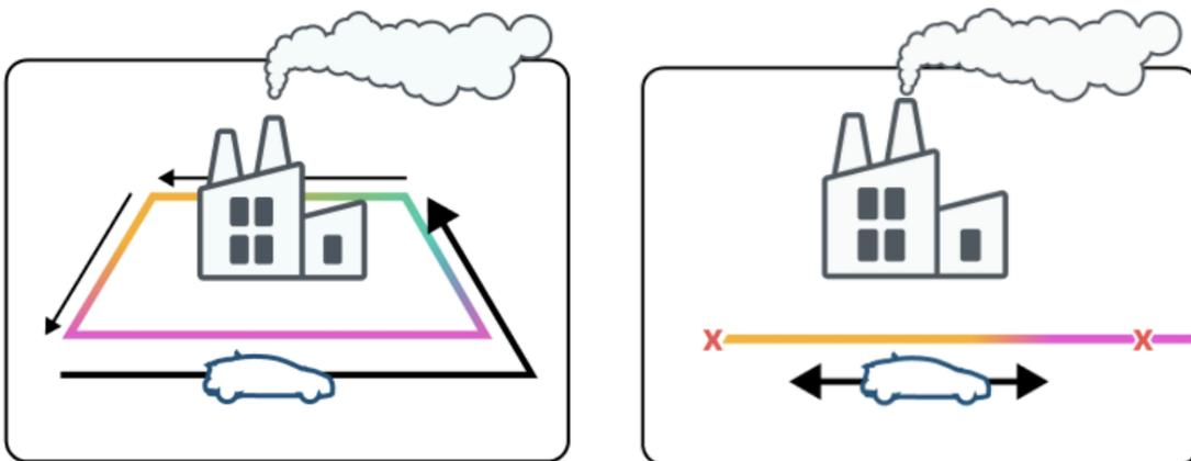
**Figura 2:** Ejemplo de técnica de medición para el monitoreo de área específica utilizando (izquierda) conducción perimetral, que sondea sistemáticamente alrededor del perímetro de una instalación o sitio fuente conocido o sospechoso, y (derecha) conducción por transecto, que sigue una trayectoria diseñada para muestrear contra el viento, dentro de, y a favor del viento de una posible pluma de contaminación proveniente de una fuente conocida o potencial.
