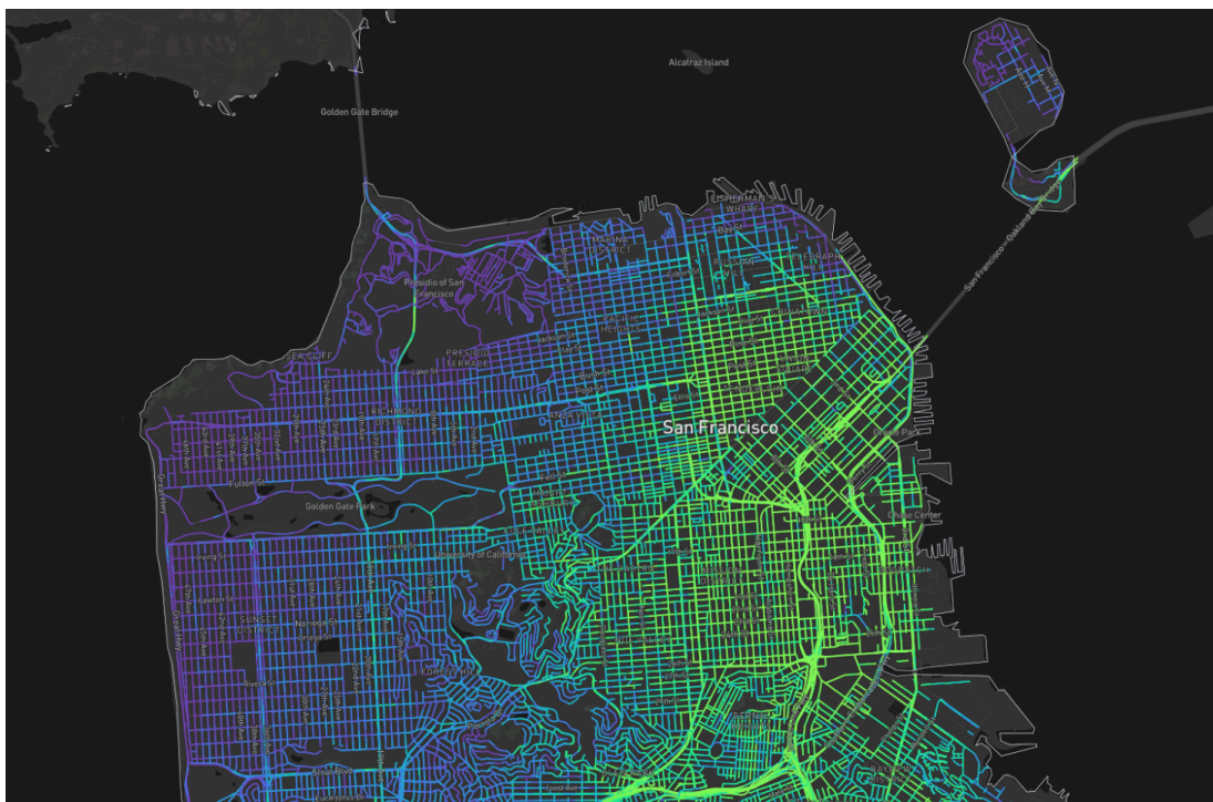
Figura 4: Ejemplo de estimaciones de concentración ambiental graficadas para el NO2 (dióxido de nitrógeno) en el Área de la Bahía de San Francisco, CA. Este gráfico utiliza datos generados por el método de monitoreo de área amplia.
